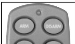
3. Die Taste ARM ON auf der Schlüsselanhängerfernbedienung KR21 drücken. Je nach Einstellung des SC2800 (5.6.) wird das System sofort oder mit Verzögerung eingeschaltet. Wird mit Verzögerung eingeschaltet, ertönt 1 Minute lang ein Bestätigungston in einer Tonhöhe.
