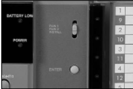
**INSTALL** - Schaltet die Zentrale in die Einstellungsfunktion zum Anmelden von Sensoren und Fernbedienungen und zum Ändern von Einstellungen.
